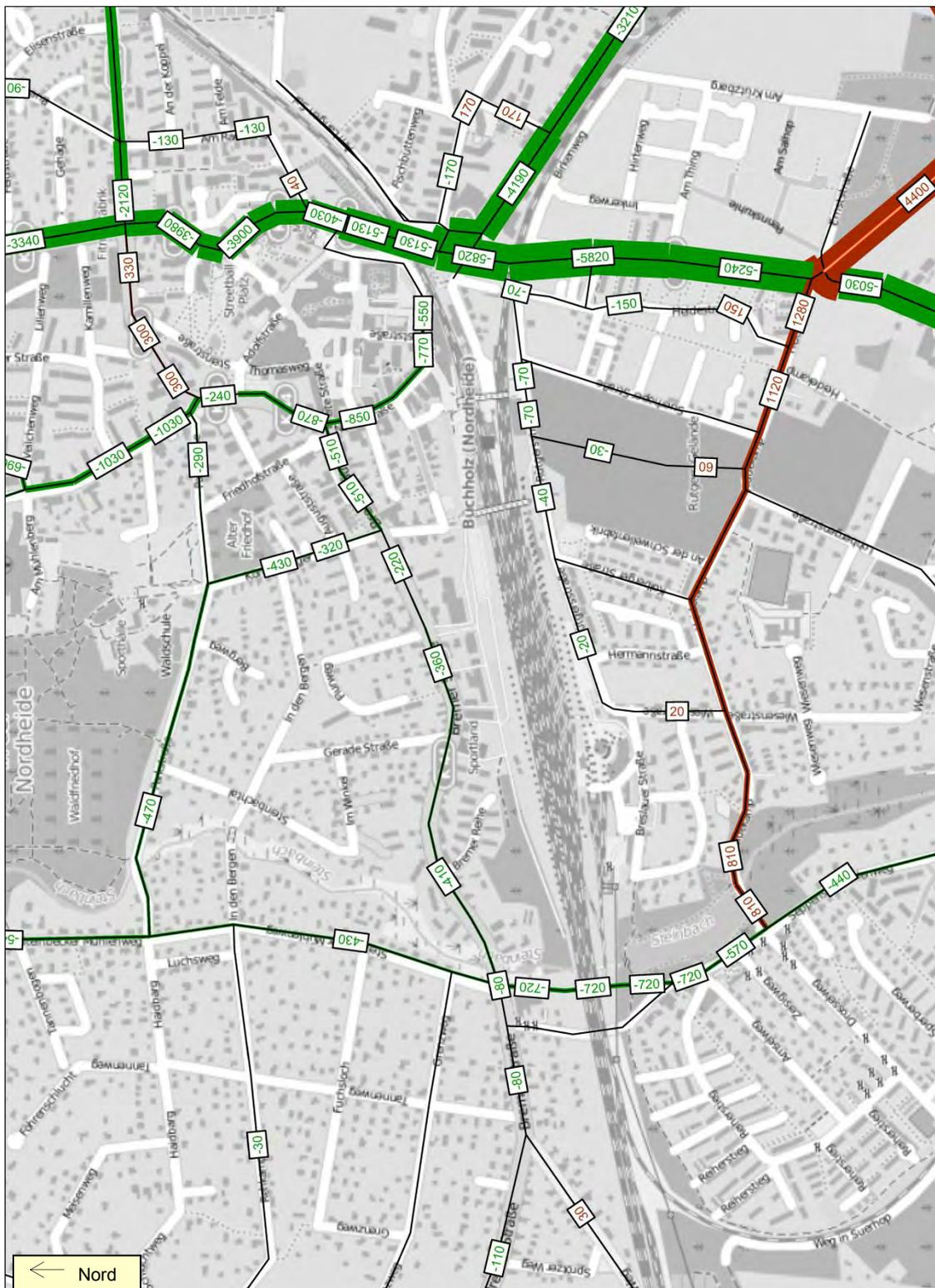
Abb. 3.4c: Differenzbelastung Planfall A 2 und A 3 – Analyse 2014 (Kfz/24 h)
