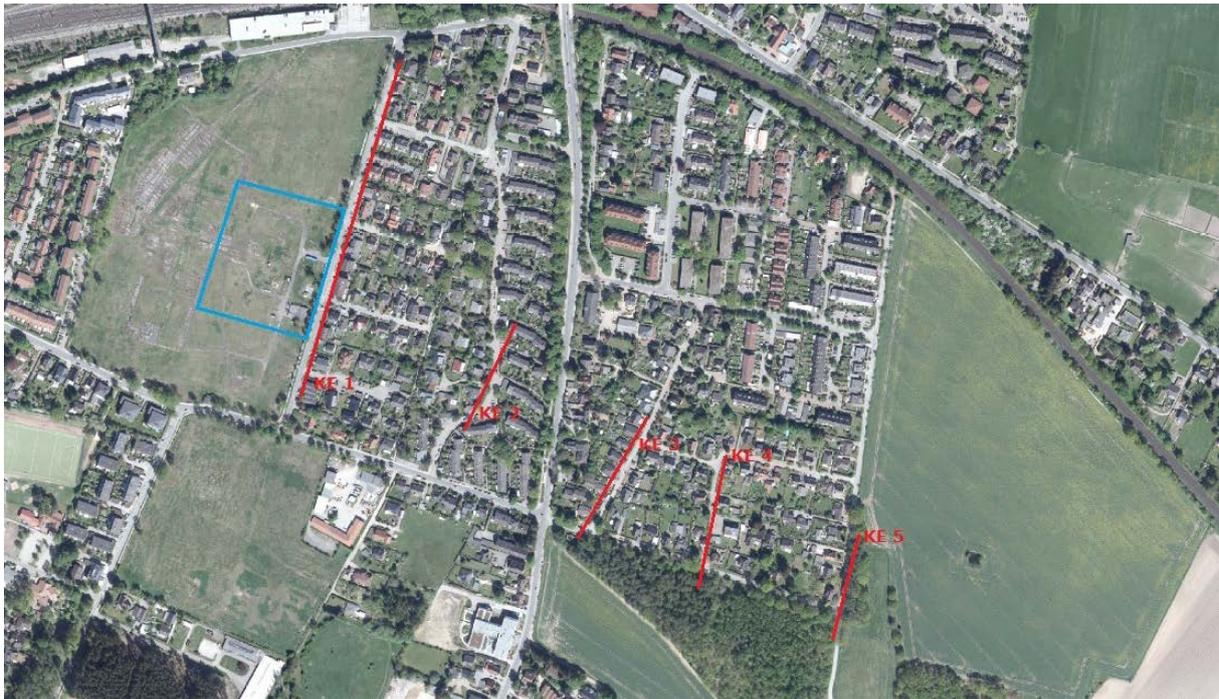
\* Darstellung der sog. Kernzone sowie der Kontrollebenen (KE) im Grundwasserabstrom
